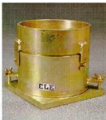
Molde do ensaio proctor
