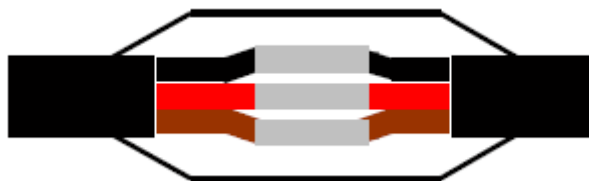
Emenda resinada com molde
